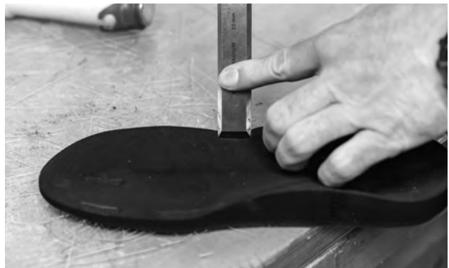
Stanzen der Stegkanäle
