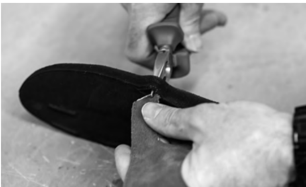
Einfädeln der Sandalenriemen
